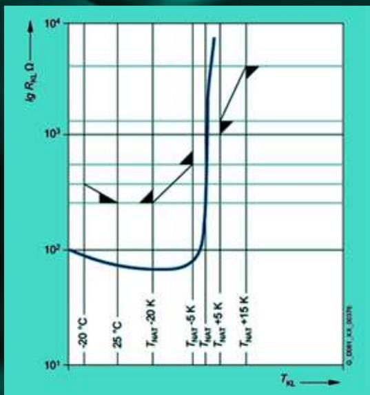
چنانچه افزایش دمای سیم پیچ الکتروموتور از محدوده مجاز خارج شود، باعث ایجاد تغییر ناگهانی در مقاومت PTC می شود و این موضوع توسط تجهیزات حفاظتی متصل به PTC تشخیص داده شده و الکتروموتور را از مدار تغذیه جدا می کند. از ترمیستور PTC نمی توان برای ولتاژها و جریان های بالا استفاده کرد زیرا ماهیت فیزیکی آن از نوع نیمه هادی است. استفاده از ترمیستور برای موارد ذیل پیشنهاد می شود:
