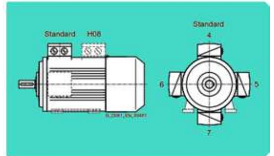
اگر یک سیستم کنترل ترمز و یا حفاظت حرارتی نصب شده باشد، کلیه اتصالات نیز درون جعبه ترمینال قرار می گیرند.
