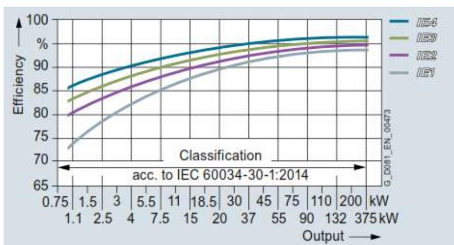
در این استاندارد میزان بازدهی الکتروموتور ها با توجه به توان خروجی و فرکانس 50 هرتز مشخص شده است.
