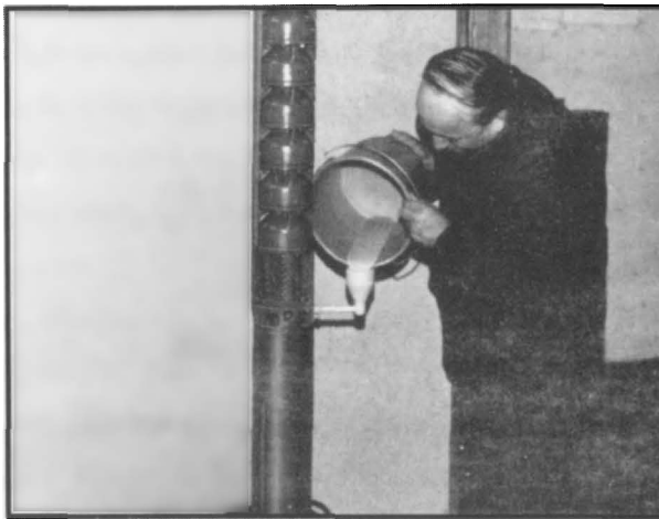
شکل ۱۶- روش آماده کردن الکتروموتور شناور
