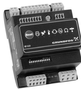
ماژول IO113 یک پورت سنسور محافظتی برای پمپ های لجن کش گراندفوس می باشد. این ماژول دارای ورودی برای سنسورهای آنالوگ و دیجیتال می باشد و در صورت ارسال سیگنال خطأ از طرف سنسورها بلافاصله پمپ را خاموش می نماید.
