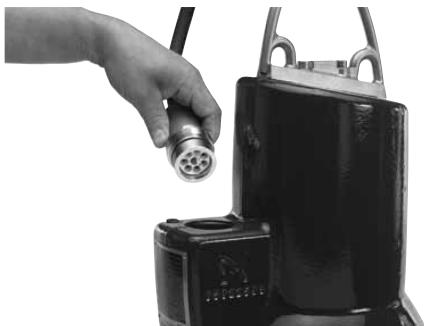
کابل به الکتروموتور به واسطه سوکت استیل و یک مهره بسته می شود و عمل آب بندی در مقابل نفوذ مایع توسط اورینگ انجام می شود.
