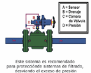
Reguladora como Válvula de Seguridad para sistema de Filtrado
