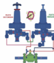
Conexión de Piloto Sostenedor + Piloto Regulador en Válvula con llave de 3 vías
