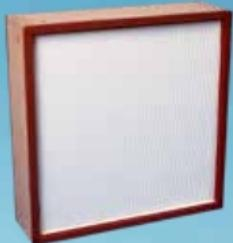
❖ **فیلتر هپا (hepa)** : این فیلترها از الیاف با جنس فایبرگلاس یا پوشال درست می شوند، که به هوا اجازه ورود داده ولی از ورود ذرات آلاینده جلوگیری کنند. برای بهبود عملکرد آنها را به صورت آکاردئونی طراحی می کنند که با افزایش چین آکاردئون، بازدهی و حساسیت آن افزایش می یابد.
