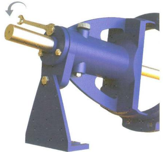
شکل ۲۴- باز کردن درپوش بلبرینگ
