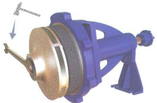
شکل ۲۰- باز کردن مهره شش گوش پروانه
