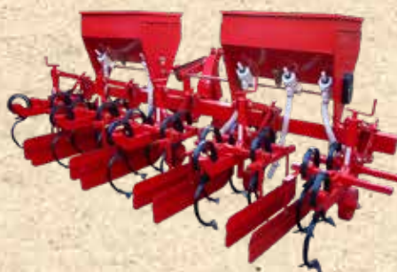
کولتیواتور با کودکار پنجه غازی گیربکسی (پی تی او گرد)
