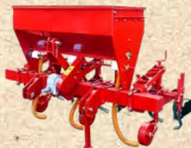
دستگاه کولتیواتور کودکار پنجه غازی مجهز به فاروئر گیربکسی (پی تی او گرد)
