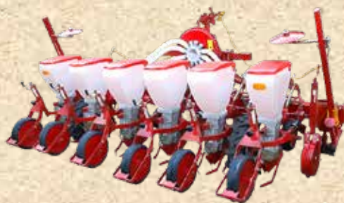
ردیفکار پنوماتیک برای کاشت دو ردیف ذرت روی یک پشته
