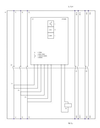
L (Long Time Delay / Überlastschutz); S (Short Time Delay / Kurzschlussschutz, kurzzeitverzögert I (Instantaneous / Kurzschlussschutz, unverzögert); F5 (Maglatch for trip unit / Ausösemagnet);
