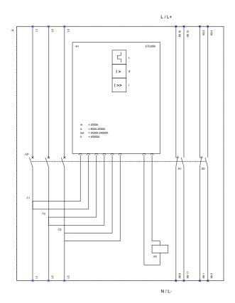
L (Long Time Delay / Überlastschutz); S (Short Time Delay / Kurzschlussschutz, kurzzeitverzögert I (Instantaneous / Kurzschlussschutz, unverzögert); F5 (Maglatch for trip unit / Ausßesemagnet);
