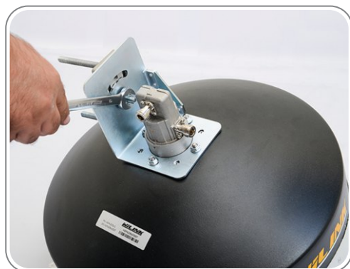
۹- نحوه بستن گیره لوله به پایه آنتن
