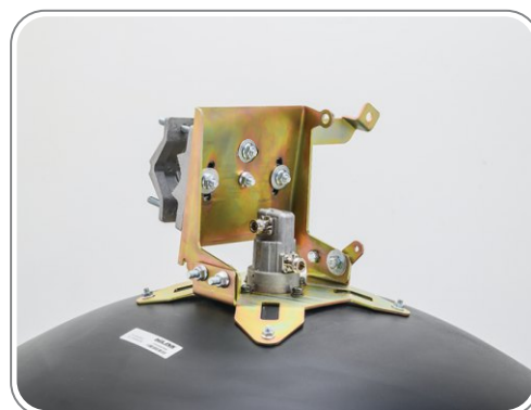
۱۵ - نصب مهارکش دوم جهت حرکت عمودی سر آنتن به صورت میلیمتری (Fine Tune)
