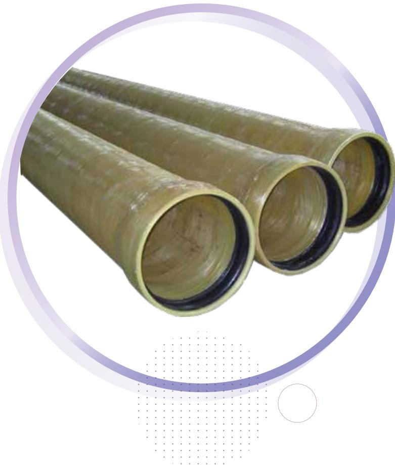
علاوه بر رزین، الیاف شیشه ای پیوسته و الیاف بریده شده، برای ایجاد استحکام حلقوی بالا و تقویت استحکام محوری بکار می روند. سیلیس نیز برای افزایش سفتی لوله بکار می رود. استفاده از دو محل ریزش رزین، امکان داشتن یک لایه داخلی رزین خاص با مقاومت بسیار بالا را برای مقابله با خوردگی سطح داخلی که در تماس با فاضلاب است، فراهم می کند.
