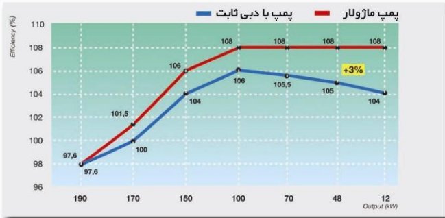
مقایسه راندمان در خروجی های مختلف بین پمپ با دبی ثابت و پمپ ماژولار در یک مودولکس
